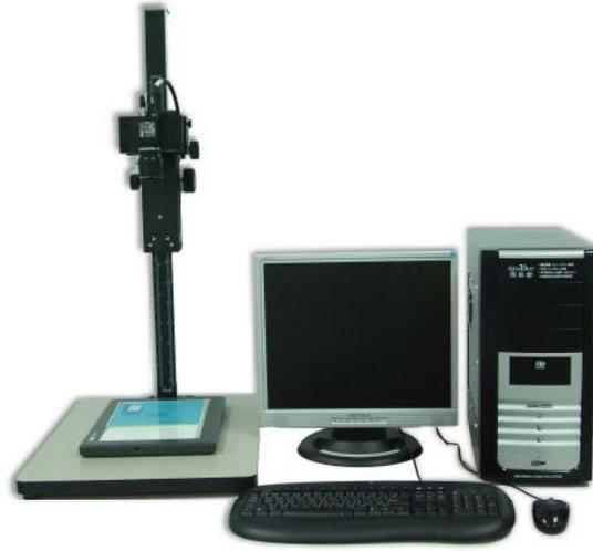
YT2600 是一台高效率 LED 晶粒計數機，應用光學檢測技術計數 LED 晶粒的數量，可計數紅光、藍光及綠光等不同類型的 LED 晶粒，計算一片 LED 晶粒的時間約為 2 秒，可檢測的 LED 晶粒最小間隔距離為 5mil，計算 LED 晶粒數量的精確度為 0.1%。YT2600 也可以計算有 Ink 的 LED 晶粒數量及沒有 Ink 的 LED 晶粒數量。簡易的系統軟體使用環境，使用者可容易操作。
